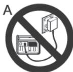
Запрещается подключать миниэлектростанцию к бытовой электрической сети или к электрическим сетям общего пользования.
