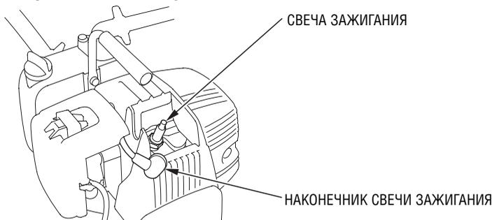
2. Осмотрите свечу зажигания. При наличии очевидных признаков износа, трещин или сколов на изоляторе, свеча зажигания не подлежит дальнейшему использованию и должна быть заменена. Если свеча зажигания будет снова установлена в двигатель, предварительно очистите ее с помощью проволочной щетки.
